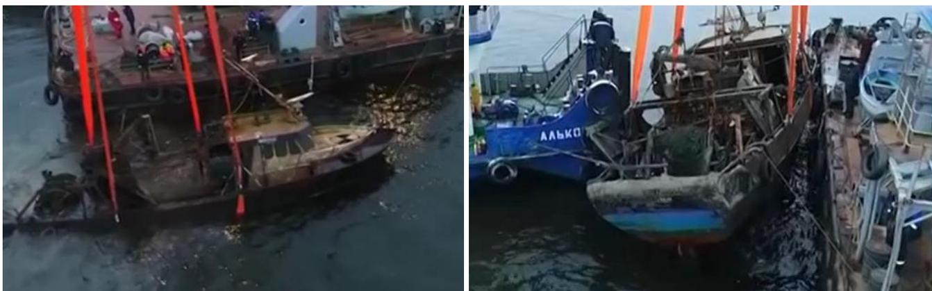
Рис. 3. Подъем МРС «МОННИ» со дна Финского залива
